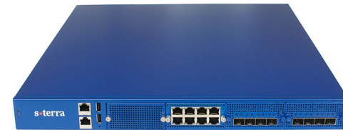
С-Терра Шлюз 3000 — до 1510 Мбит/с С-Терра Шлюз 7000 — до 5710 Мбит/с С-Терра Шлюз 8000 — до 9290 Мбит/с
